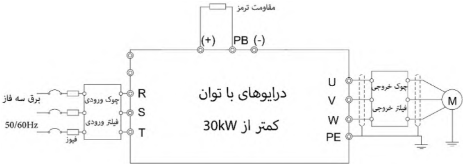
شکل ۴-۴: دیاگرام سیم کشی مدار اصلی برای 30kW و مدل های پایین تر
